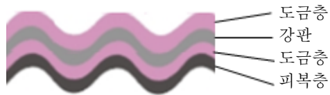
그림 1 — 일반형 강관 및 유공관의 내면 피복 강판의 단면 모양
