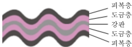
그림 3 — 일반형 강관 및 유공관의 양면 피복 강판의 단면 모양
