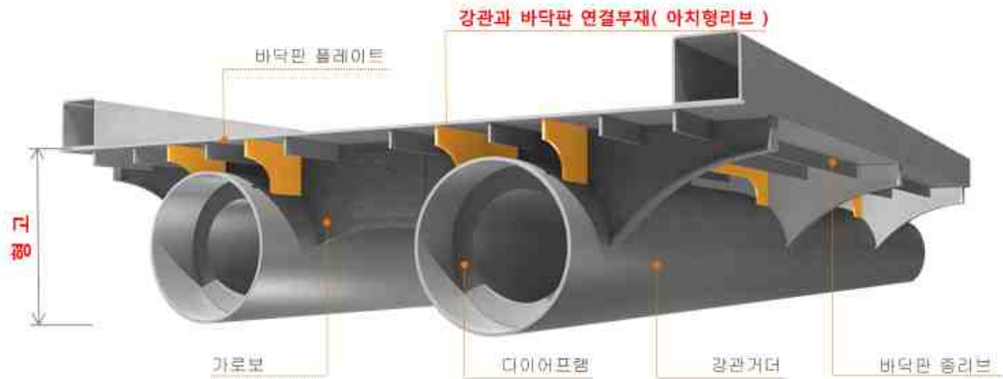
AR 강관거더(Arch-Rib Steel Tube Girder) 개념도
