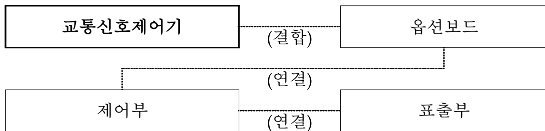
[그림 5] 교통신호제어기와 제품 구성 요소의 연결
